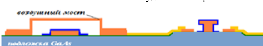
Рис. 8. Технологический маршрут совместного изготовления МШУ на основе гетероструктур AlGaAs/InGaAs/GaAs и МЭМС переключателя
